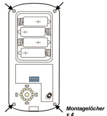
**Vor der Montage den Sabotagekontakt gemäß der Betriebsanleitung der Alarmzentrale vorübergehend deaktivieren, damit der Alarm nicht versehentlich ausgelöst wird.**
